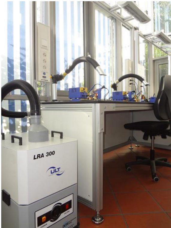
Bild 4: Schulungsbereich für Handlöt-Seminare der SEHO Academy mit Absaugvorrichtungen an jedem Arbeitsplatz
