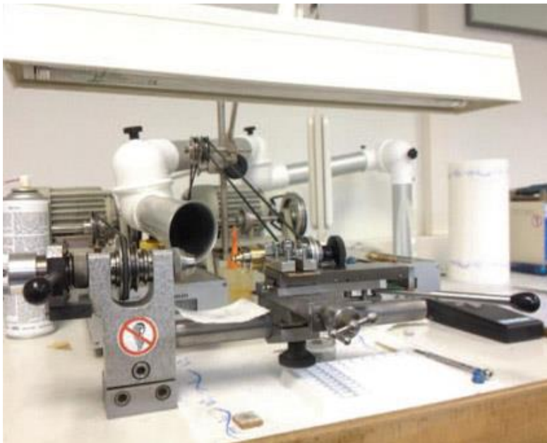
Bild: Speziell konfigurierter Absaugarm an einer Drehmaschine (Bildquelle: Lange Uhren)
