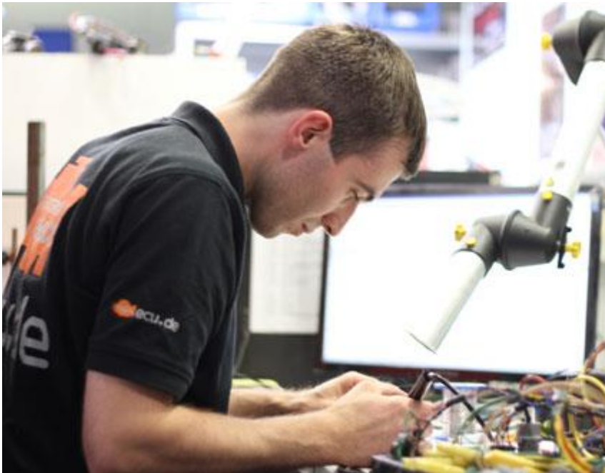
Bild: Lötarbeiten am Steuergerät – Schadstoffeffassung mit Alsident-Absaugarm
