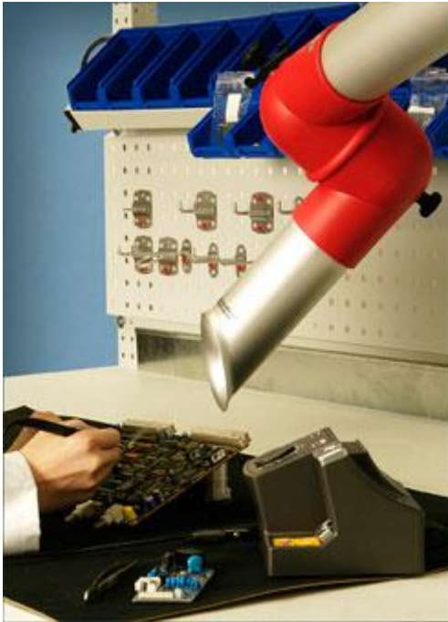
Bild 4: Lötrauchabsaugung an manuellem Arbeitsplatz – Einsatz einer Saugspitze am Absaugarm
