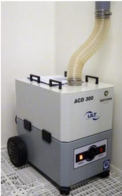
Bild 5.2: Zentrale Absauganlage für mehrere Laborarbeitsplätze
