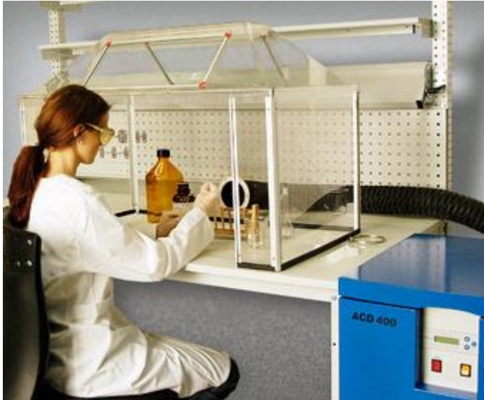
Bild 6: Halboffenes System als Erfassungselement – über einen Schlauch mit der Absauganlage verbunden
