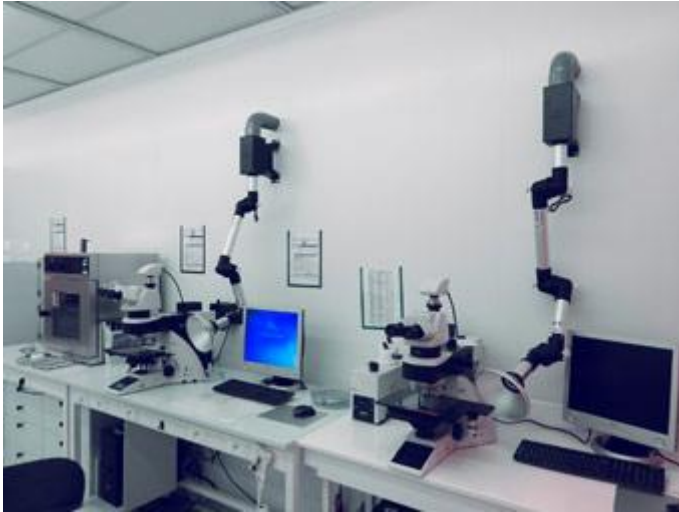
Bild 5.1: Einsatz von Absaughauben in einem französischen Labor
