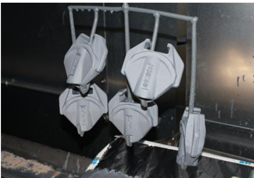
Bild 4: Gussteile nach Beschichtung im Tauchbad mit Primer
