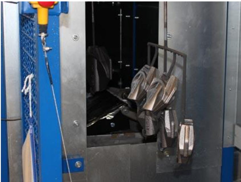
Bild 3: Gussteile an Kettentransportband vor deren Benetzung im Tauchbad mit Primer
