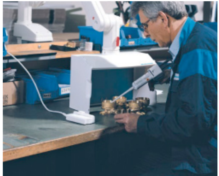
Bild 2: Beispiel für das Prinzip "so nah wie möglich" Einkleben von Dichtungen in Drehdurchführungen
