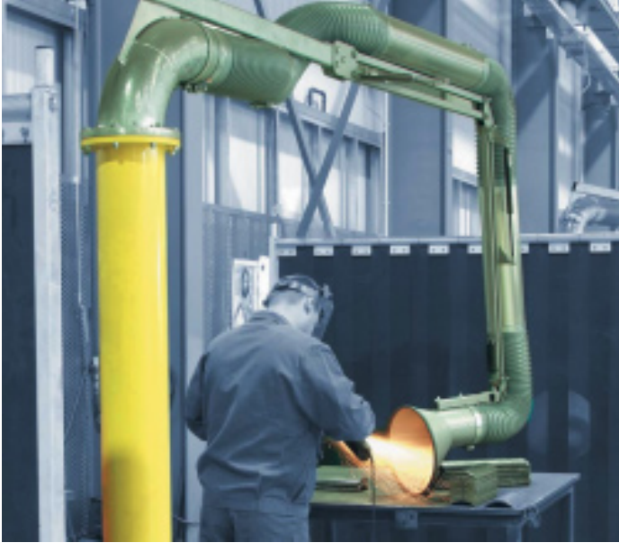
Bild 7: Beispiel für die Nutzung des Austrageimpulses Schleifen mit handgeführtem Werkzeug
