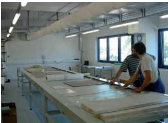
Bild 1. Zuschnitt der Glasfasermatten
