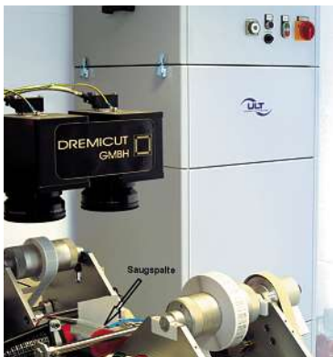
Bild 2: Die ULT-Absaug- und Filtereinrichtung an Laserbeschriftungsanlagen schafft Reinraumbedingungen durch Absaugung des Laserqualms direkt am Entstehungsort.
